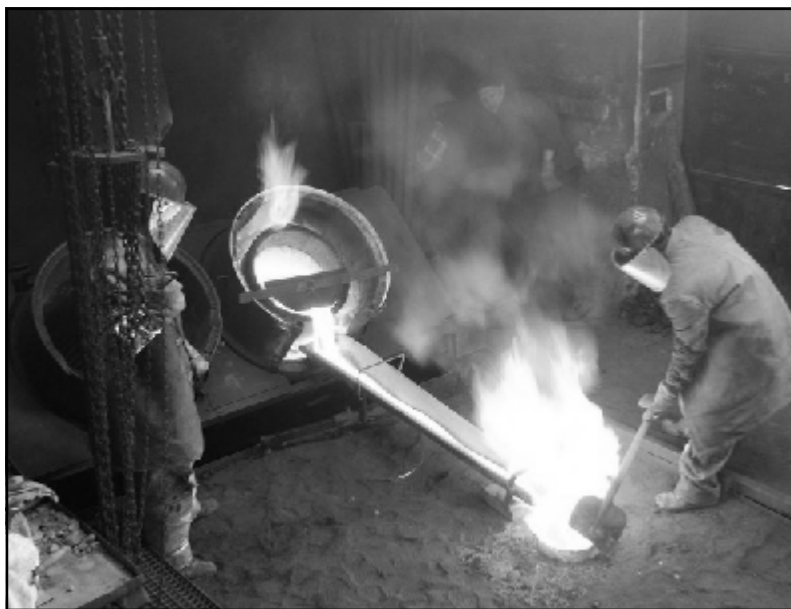
Odlévání zvonu Arnošt ve zvonařské dílně v Brodce u Přerova
